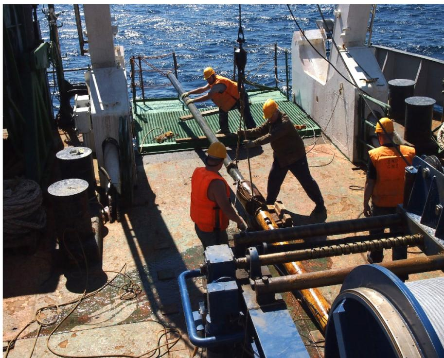
Fig. 4.6. Hydrocorer.
