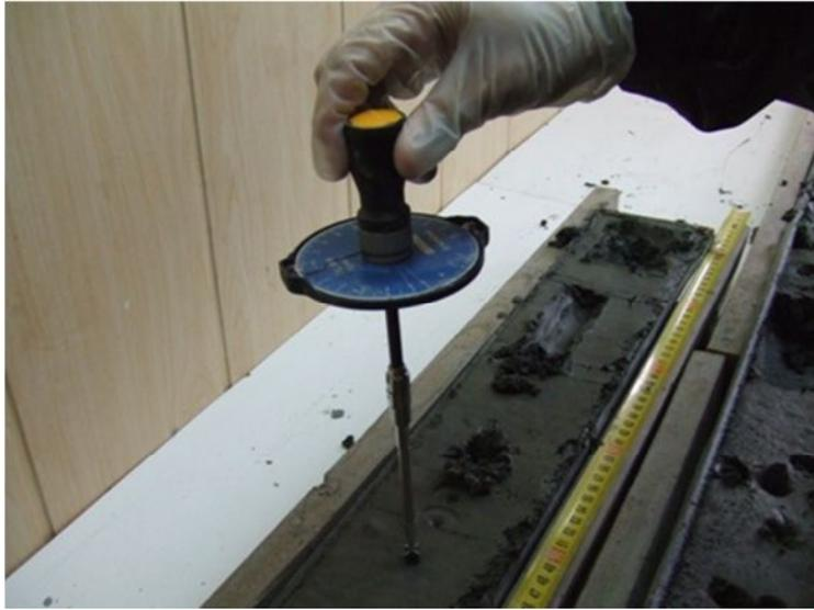
Photo 3.3.4.1. Vane shear test
