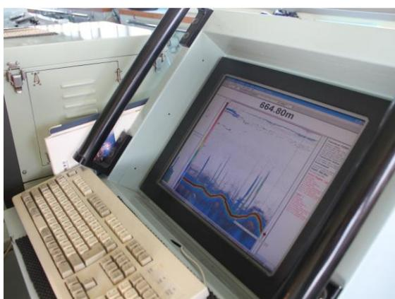
写真 3.2.1 計量魚群探知機のモニタ（船橋）
