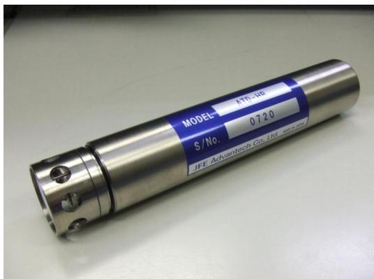
写真 3.2.6 温度圧力計 (ATD-HR)
