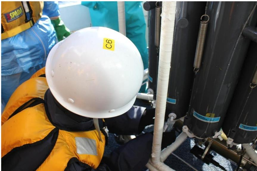
写真 7.2 CTD 採水実習の様子 (ニスキン採水器からのサンプリング)
