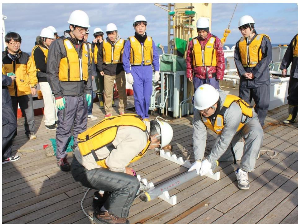
写真 6.1 採取コア（内管）の半制作業
